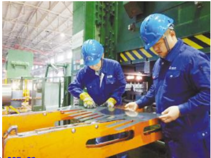
日前,官地2号机定子冲片返修任务高效完成。冲剪分厂克服了生产周期紧张、设备和工具等资源不足的困难,在平衡和满足其它项目产品生产需求的同时,高效组织该返修任务,按期、保质地完成了该紧急返修任务,满足了用户需求。图为生产人员正在自检官地冲片
