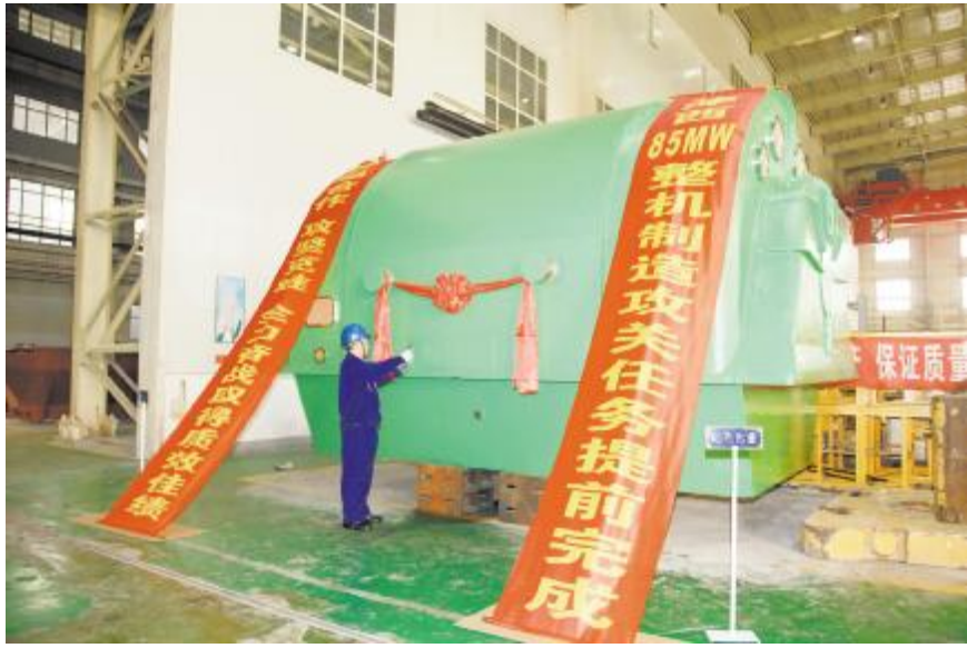
整装待发的津西 85 兆瓦机组定子
