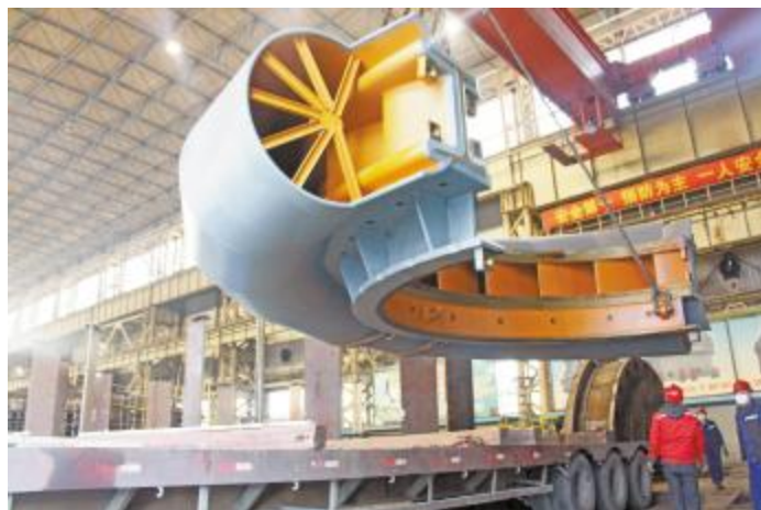
日前,溧阳6号座环壳成功发运。至此,大件公司完成了江苏溧阳抽水蓄能电站5台座环壳的生产任务。在生产过程中,大件公司采取了多种措施,有效控制了溧阳系列产品的质量与进度。图为溧阳6号座环壳正在吊运
