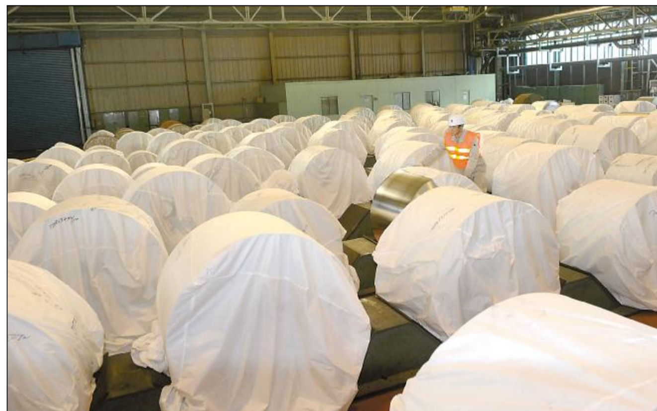
一段时间以来,上海阴雨连绵,气温起伏较大,宝钢股份镀锌板厂强化季节性防锈露工作,从结露预警、器材准备、人员培训、巡检督查等多方面推进落实,成功应对天气变化,做到无一卷钢卷锈露锈蚀。图为工作人员在现场为钢卷套防露罩作业。
