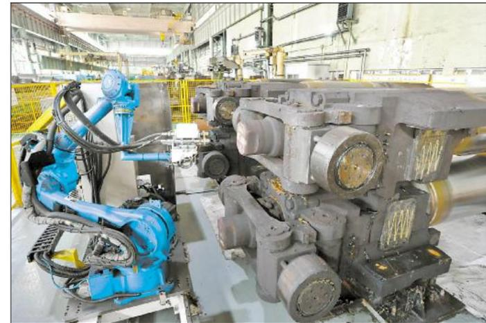
由宝钢工程技术集团自主研发的机器人自去年四月在宝钢股份热轧厂5080吨辊线投入运行以来,通过不断优化,注油准确率、注油油品准确率、辊线识别准确率等关键指标达到百分之百。该机器人的投入,既提高了劳动效率和作业效率,降低油脂消耗,又杜绝了补油安全隐患,大大提升辊线间环保水平。
