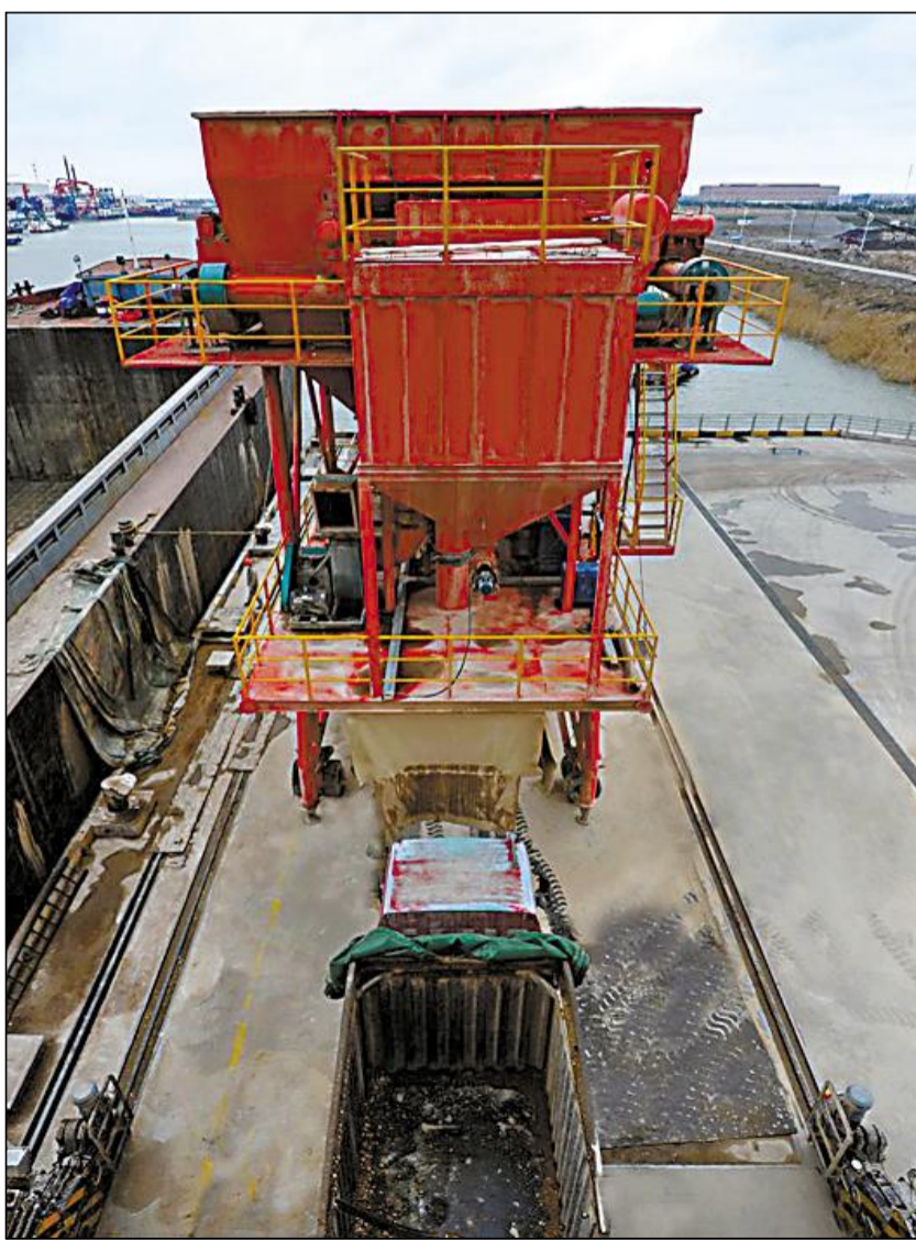
宝钢物流(江苏)有限公司海宝码头采用抑尘料斗和移动式雾炮,通过近半年的使用,有效地解决了作业时的扬尘问题,装卸损失率由原来的7%降到了现在的3%,得到了当地政府和用户的一致好评。图为码头作业中的抑尘料斗。
