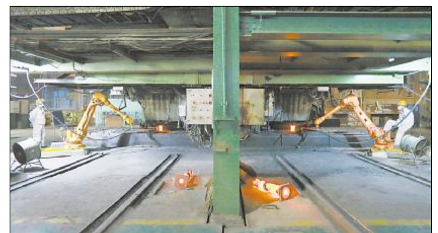
梅钢炼钢厂首个工业机器人应用项目——2号连铸机自动加渣系统近日完成热负荷试车投入使用。通过自动机械手实现智能、均匀、定量添加连铸保护渣的功能，完全代替人工操作。
