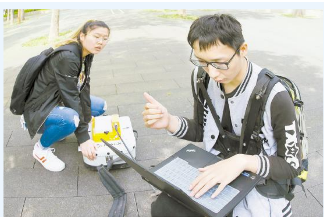
日前,武钢集团绿色城建公司邀请武汉大学水文检测人员在武汉市青山区南干渠游园对地下水流量、流向进行检测分析。据了解,南干渠游园是该公司承建的武汉市海绵城市示范工程,工程总面积达400公顷,自2017年10月完工向市民开放游园以来,绿色城建始终围绕“渗、滞、蓄、净、用、排”六字方针,跟踪分析运用地面渗透、地下排水等关键数据,开展施工与运维管理。该项技术经过提炼与总结,适时推广应用至同类工程建设。 特约记者 朱旺春 摄影报道
