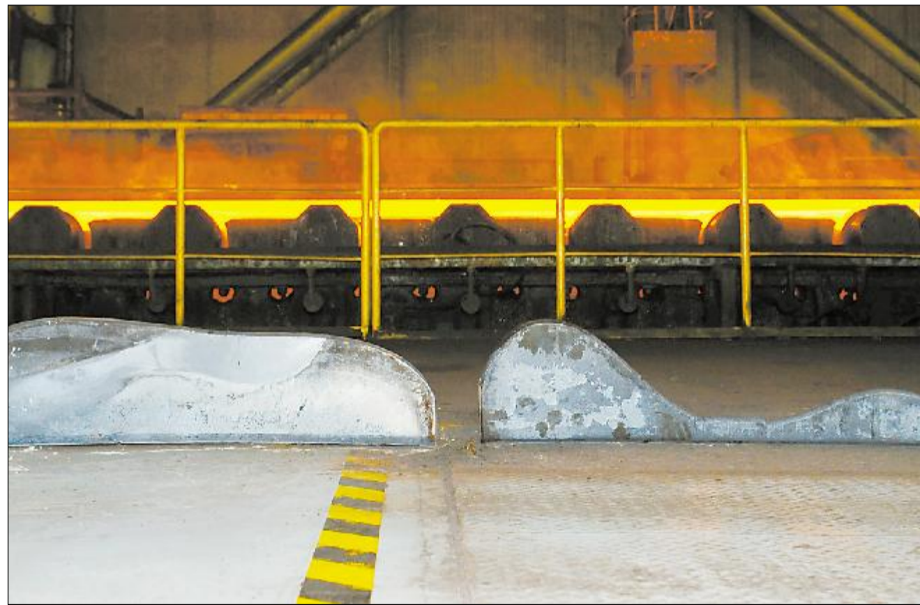
宝钢股份宝山基地热轧厂 1880 单行线加大现场成本改善力度,对切损精度开展技术攻关。通过改进设备状态,细化数据管理等措施,实现了坯头尾剪切精确控制。4 月,切损率同比下降 12%。图中左侧为攻关前剪切的坯头,右侧为实施精确控制后剪切的坯头。
