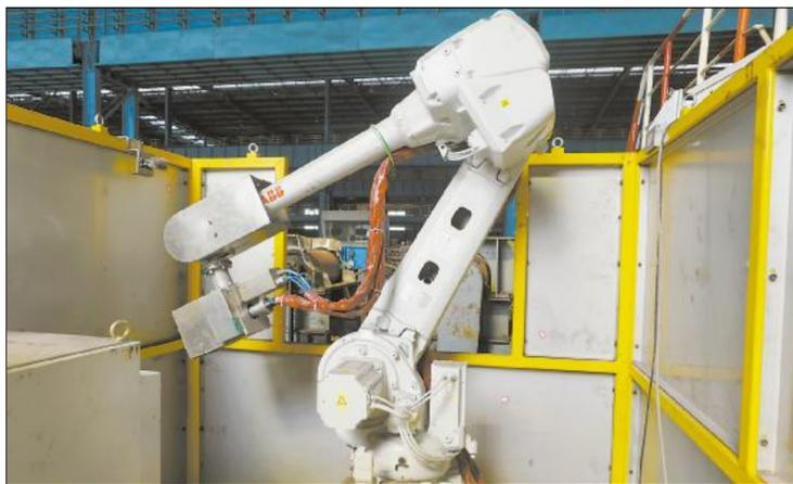
在公司大力推行智能制造的背景下,超钢特轧厂特棒分厂大棒生产线方坯收集架采用了六轴机器人,目前已完成安装调试并投入运行,既节约了人力成本,还可提升作业效率近百分之二十。
