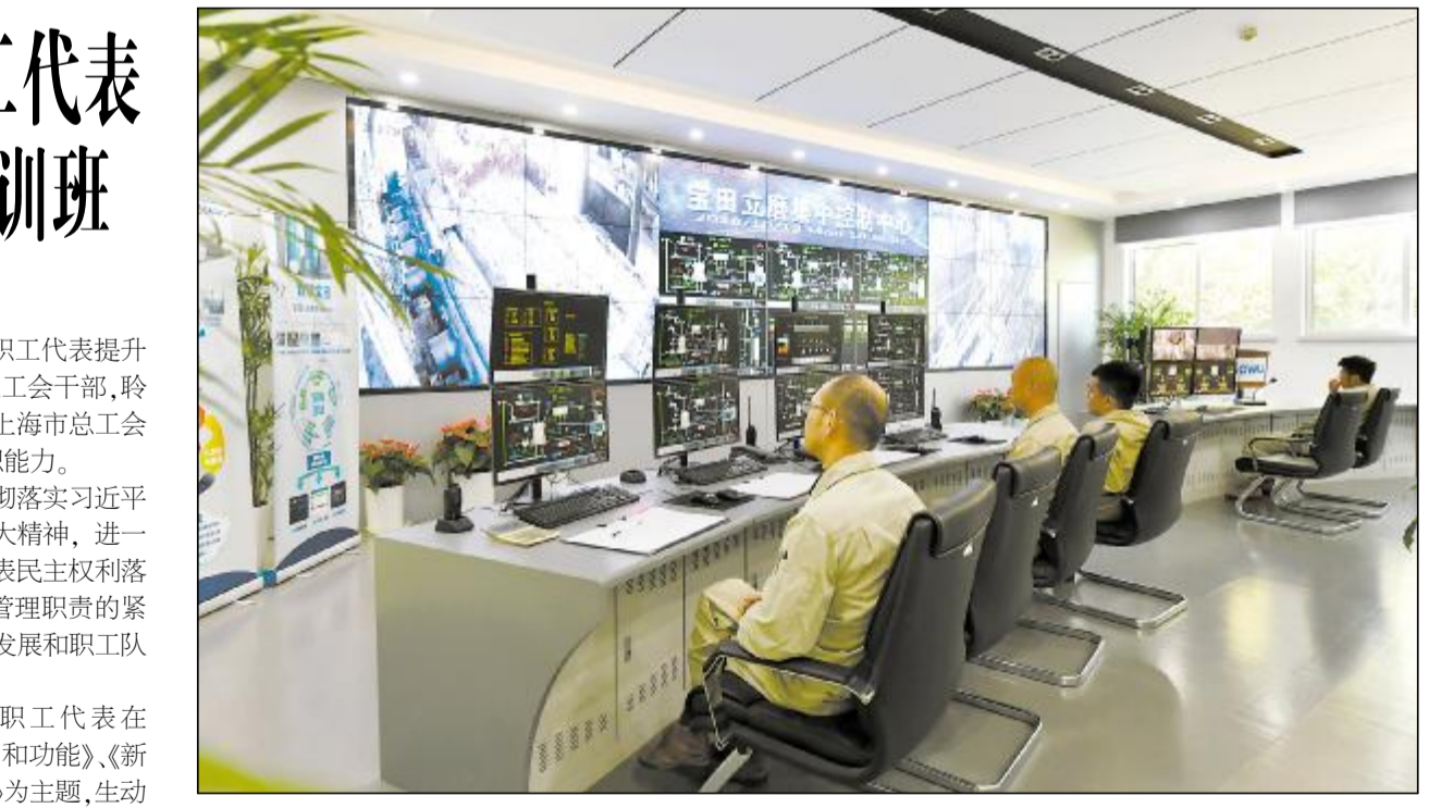
宝武环科宝武建材以打造“矿渣微粉行业智慧制造的领先者”为目标, 日前正式启用宝武田立磨智能化集中控制中心(如图)。新控制中心取代了原来的1号、2号、3号、5号生产系统以及发货系统, 通过一体化操作实现了远程诊断、故障预判, 并减少了人工巡检, 提高了工作效率。 记者 施琮 通讯员 施莹莹 摄影报道
