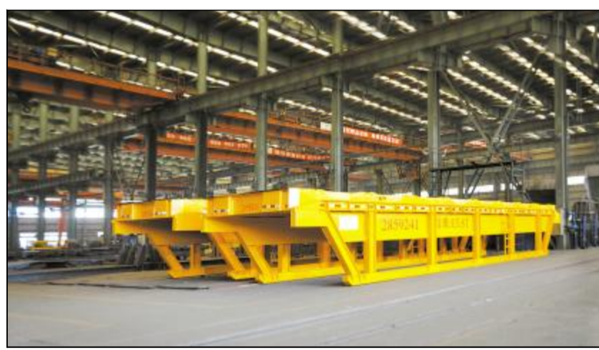
日前,由中冶重机制造的宝钢股份运输部6台12M H型四高强框架车完成最后一道工序,整装待发。本次6台框架车专门用于宝钢股份宝山基地区域内冷、热轧钢卷材、管材、板材等钢制品运输作业。框架车设计总载重能力达120吨以上,主要钢结构安全系数不低于2.0。主体结构采用宝钢股份在国内率先研发、具备优良的承重及抗弯能力的BS700MCK2高强结构钢。通讯员 沈其锋 摄影报道
