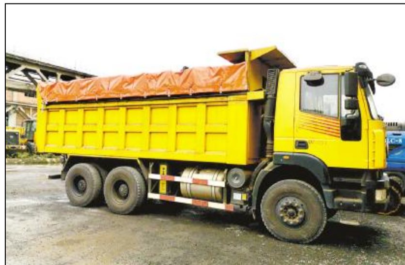
为杜绝车辆作业过程中扬尘,韶钢物流部汽运车间近日对运送石灰类散装物料车辆进行了集中改造。改造后的车辆都安装了可伸缩的篷布,操作方便,环保高效。特约通讯员 陈立新 通讯员 郭士震 摄影报道
