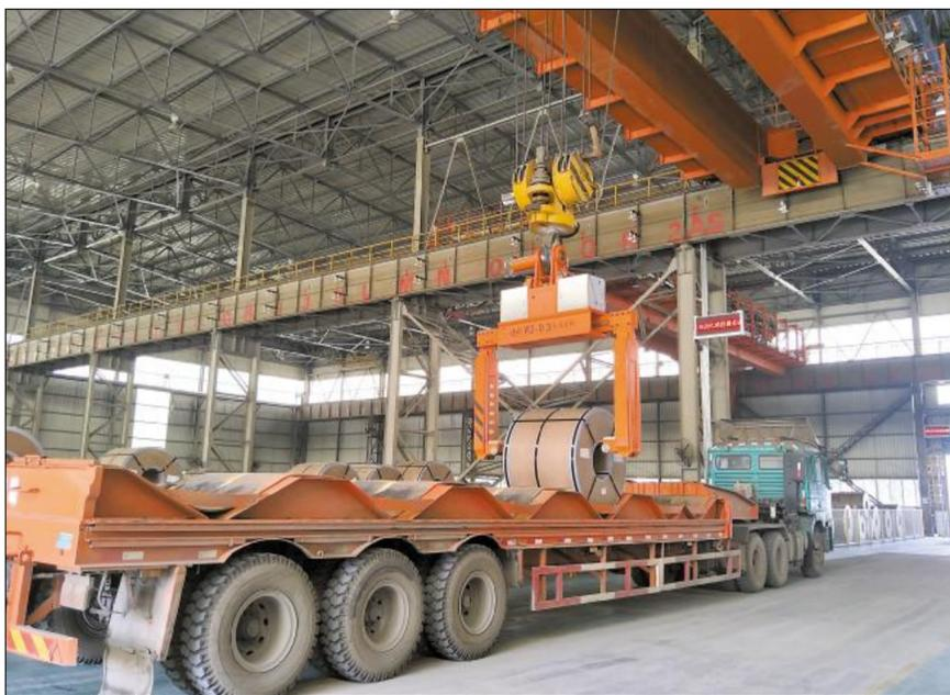
日前,梅钢成品码头3号库区行车智能化改造项目试车成功,比计划提前一周投产。项目由中冶宝钢第二分公司承接,于去年11月14日开工,主要对3号库区4台行车增配无人全自动电气系统设备及地面配套设施集中改造。项目属于在线改造,均利用生产间隙时间进行。
