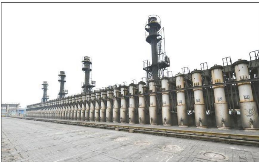
今年6月,宝钢股份宝山基地炼铁厂专门成立“黑金之光”团队,针对炼铁生产流程查找对策,运用多种炉体维护技术,创新开发使用新材料等方法进行三期炉体设备的维护和改造。8月,炼铁厂焦炭产量提升1.21%,炼焦区域可视污染攻坚战初战告捷。图为装煤作业完毕后的焦炉炉顶。 记者 张勇 通讯员 许军 摄影报道
