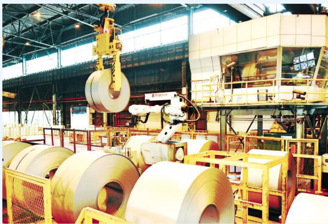
宝钢股份宝山基地冷轧厂C102机组运行已超过三十年,机组先后通过技术革新和设备改造,严格现场准备和生产过程管控,顺利实现机组刷新,二〇一四年改制“四班两运转”的班产记录后,日前,轧机甲班又传捷报,班产记录再次刷新。图为C102机组入口段自动拆捆以及自动行车上料。
