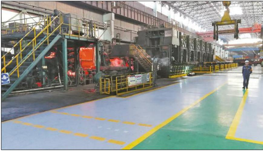
日前,由梅钢热轧厂表亚东创新工作室自主创新开发的梅钢热轧1422产线热卷箱水雾除尘系统正式投用,开创了国内热卷箱水雾除尘自主创新的光彩。这是自2005年热卷箱投用以来,第一次实现区域氧化铁皮粉尘的“天绝”,梅钢热轧1422产线热卷箱区域彻底告别了“灰头土脸”的形象,再也不见了粉尘飞舞、地面积尘的现象。该装置结构简单、安装方便,具有较强的经济性,实用性,推广应用前景广阔。目前,这项技术创新成果已申请专利。
