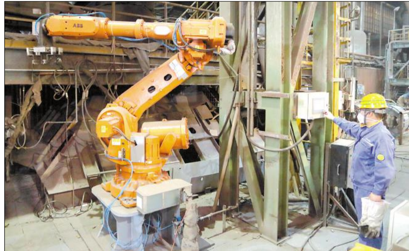
近日,宝钢股份梅钢公司二炼钢四号吹氩站机器人热试成功,实现了插板探头与自动测温联动。投用后可代替人工进行钢水测温、取样、定氧等操作,降低员工劳动强度,并提高测量结果的稳定性。图为机器人正在配合生产操作。
