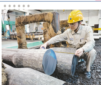
宝武特冶锻造工艺区域工程师胡仁民现场攻关,通过完善操作方法,加强标准化作业,使产品成件率大大提高。
