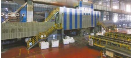
自2020年12月中旬以来,梅钢炼钢厂四号连铸机逐步稳定实现1.6米/分钟工作拉速下的结晶器在线热态调宽,突破了业内0.8-1.4米/分钟的拉速标准,创国内同类连铸机在线调宽最高拉速纪录。
