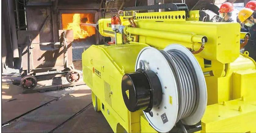
近日，宝钢资源武钢资源源湖球团分公司回转窑用上了远程操控大块处理机器人。使用机器人后，不仅降低了劳动强度、提高了作业效率，而且极大改善了作业人员的工作环境，降低了员工工作中被高温烫伤的安全风险。该机器人采用无线电信号系统全液压驱动技术，实现了球团回转窑大块图像识别、炉门启闭、移除、扒渣、破碎等功能，是机器人技术从纯粹运动学领域向工程动力学领域的新尝试。
