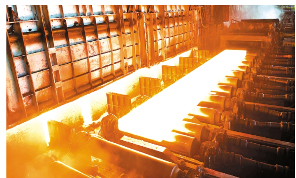
宝钢股份一季度生产形势喜人,各项生产指标向好。宝山基地热轧厂与制造管理部、炼钢厂高效协作,3月,400℃以上板坯热送率达50.43%,创历史新高。图为热轧厂2050产线热送装区区域。张勇 刘春会摄
