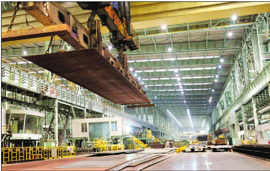
平直度一次合格率是衡量高强特厚钢板的关键技术指标。今年以来，宝钢股份宝山基地厚板厂专门成立平直度技术攻关保障团队，通过设备能力挖潜和过程数据挖掘，高强特厚钢板平直度一次合格率同比提升36%，产品质量和交货能力得到用户高度认可。图为优质特厚板整装待发。 记者 张勇 通讯员 费凡 摄影报道
