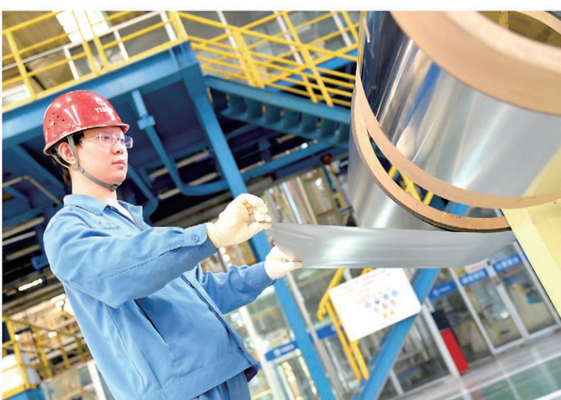
▼2018年3月，太钢生产出厚度0.02毫米、宽度600毫米的不锈钢精密带材（手撕钢），产品实物质量达到国际领先水平。太钢成为世界上唯一可批量生产宽幅状态不锈钢箔材的企业。2018年11月，太钢集团“手撕钢”产品入选“伟大的变革——庆祝改革开放40周年大型展览”。2019年7月，太钢集团“宽幅超薄精密不锈钢工艺技术及其系列产品开发”项目荣获冶金科学技术奖唯一特等奖；2020年，获中国工业大奖。
