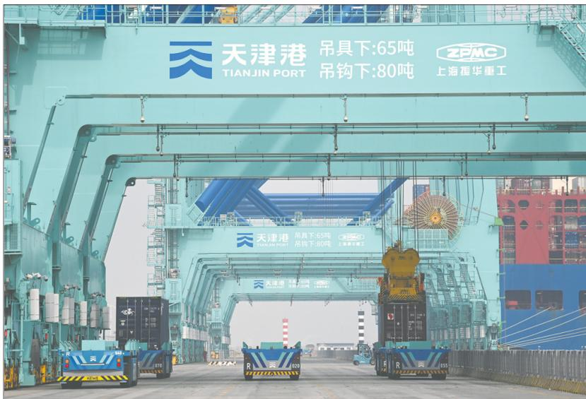
日前,天津港“智慧零碳”码头吞吐量突破100万标准箱。自2021年10月17日正式投产运营以来,天津港北疆港区C段智能化集装箱码头以全新模式为港口智能化升级和低碳发展提供了样本。图为智能水平运输机器人在天津港北疆港区C段智能化集装箱码头作业。新华社供图
