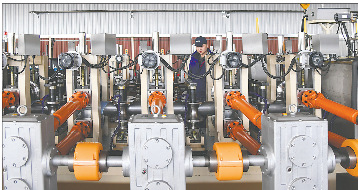
宝钢持续在补齐产业链短板上作文章。去年以来，宝钢不锈钢工业园吸引3家新企业入驻，总投资6000万元建设的12条数控不锈钢制管生产线目前已进入投产阶段，全面运行后每年可生产不锈钢管2万吨，应用于煤矿、石油化工等行业。图为不锈钢工业园工作人员在数控生产线生产不锈钢管。 特约通讯员 王旭宏 摄影报道
