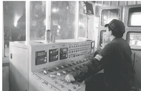
▲25吨转炉操作台
