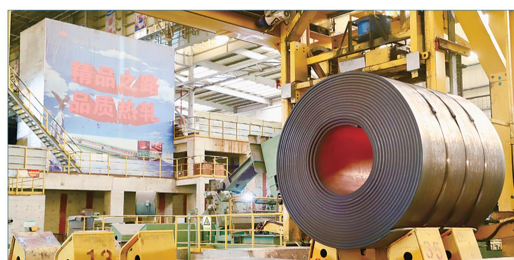
近日,在山钢日照热轧厂2050毫米热轧生产线上,一卷银灰色的钢卷在轰鸣声中顺利完成卷取工序,标志着山钢日照首卷30毫米超厚规格热轧卷试制成功。这一突破不仅刷新了该产线原设计25.4毫米的厚度极限,更开创了“超厚规格热轧卷+螺旋焊管”的制造新模式。这项突破性成果的应用前景广阔,可应用于海底管桩、输水管道等领域。
