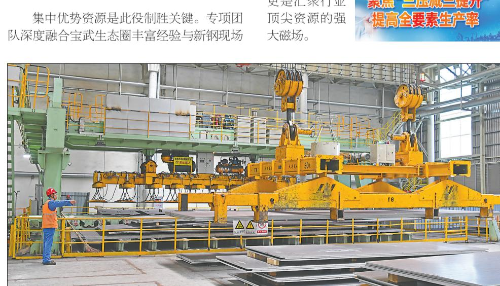
太钢集团太钢不锈热轧厂聚焦船板、双相钢等核心品种，开展班组“降低返工品率”专项竞赛。各班组轮番上阵攻关，通过强化设备点检、优化轧制温度曲线、调整轧辊压力参数，产品表面缺陷率较竞赛初期降低2.13个百分点，成材率提升0.9%，客户质量异议率同比下降近四成。
