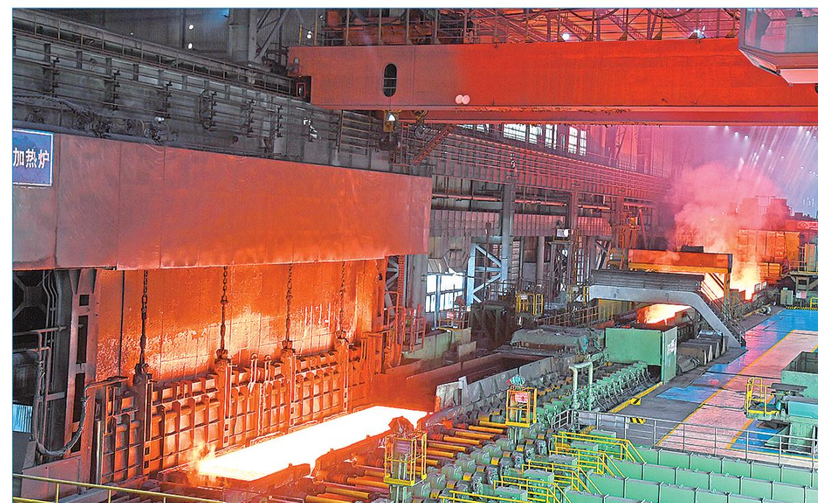
1月7日,太钢集团热连轧厂2250毫米生产线加热炉富氧燃烧改造后稳定运行。这项技术改造助力加热炉节能量提升12%以上,年节约煤气60万吉焦,降本超千万元,以科技创新推动企业实现环保与经济双丰收。
