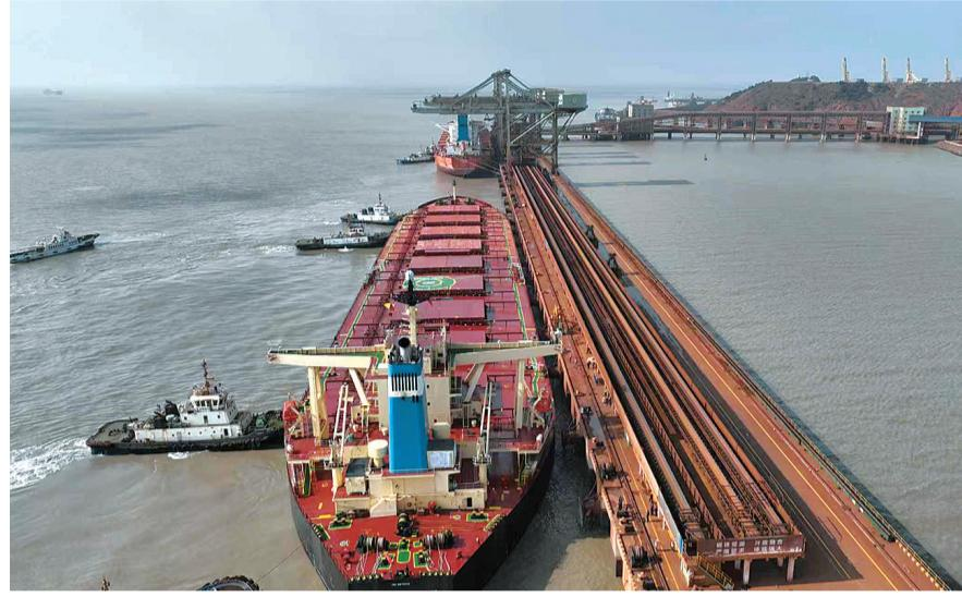
效抓取,再经由传送带卸货至堆取料场。第一时间完成卸货工作后,首船海进江2.4万吨铁矿石,将由宝武资源自有船舶“宝航16轮”运往宝钢股份宝山基地。
