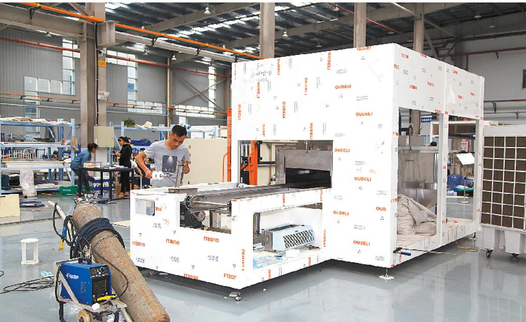
江苏科沛达半导体科技有限公司是一家专业从事清洗半导体设备制造的企业,科沛达的落户投产迅速填补了我市半导体材料和设备产业的一项空白,成为产业链条上的重要节点项目。目前企业年产值可达一亿元,年生产清洗线达 100~120 台。图为技术人员正在组装机器。陈谢 摄
