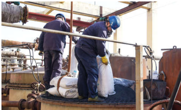
11月20日，树脂厂氯乙烯车间按生产工艺要求，组织人员对氯乙烯系统生产介质触媒进行更换。更换后，将进一步促进氯化氢和乙炔反应率，提高转化率，为保证聚氯乙烯产品质量打下坚实基础。图为操作现场。
