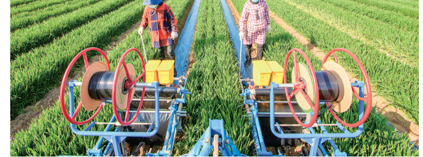
3月25日,柘城县与省农科院园艺研究所合作,在柘城国际辣椒小镇万亩辣椒种植示范区开展“辣椒丸粒化直播新技术”应用工作。即将辣椒种子直接播种在田间,改变了辣椒集中育苗和移栽传统方式,每台直播机每天可播种30亩以上,为辣椒产业推行机械化作业进行探索和试验示范。
