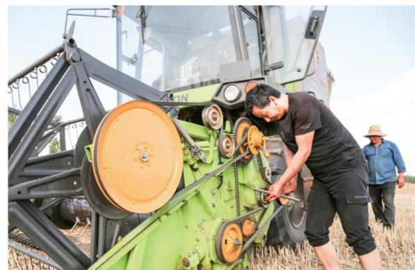
日前,宝丰县农机中心技术人员在前营乡邵湾村为农户的小麦联合收割机检修并更换传动带。麦收临近,该中心组织技术人员前往当地农机合作社、农机维修网点,对农户的小麦联合收割机、搂草机、秸秆打捆机、播种机等农机进行保养调试和检测维修,为收获小麦做好保障。王双正摄
