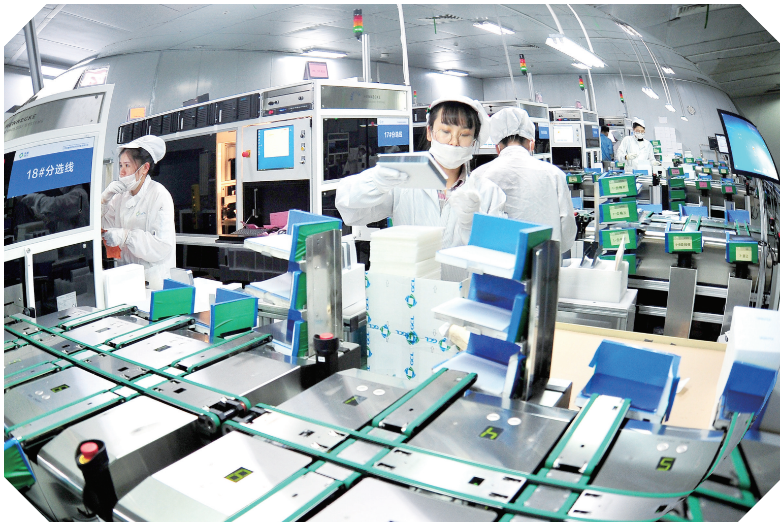
今年以来,协鑫硅材料科技有限公司新一轮技改扩能全面启动。正在实施的全自动硅片分选线技改项目,检测参数指标增加了数十项,确保了硅片产品的高质量。图为繁忙有序的分拣车间一角。
