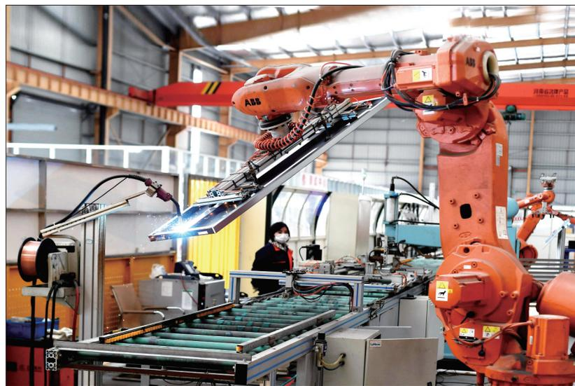
日前，徐州华恒机器人系统有限公司推出新一代ABB2600焊接机器人，升级了传统的焊接工艺，开拓了三轴零件的智能焊接新路径。图为技术人员正在调试机器人焊接系统。
