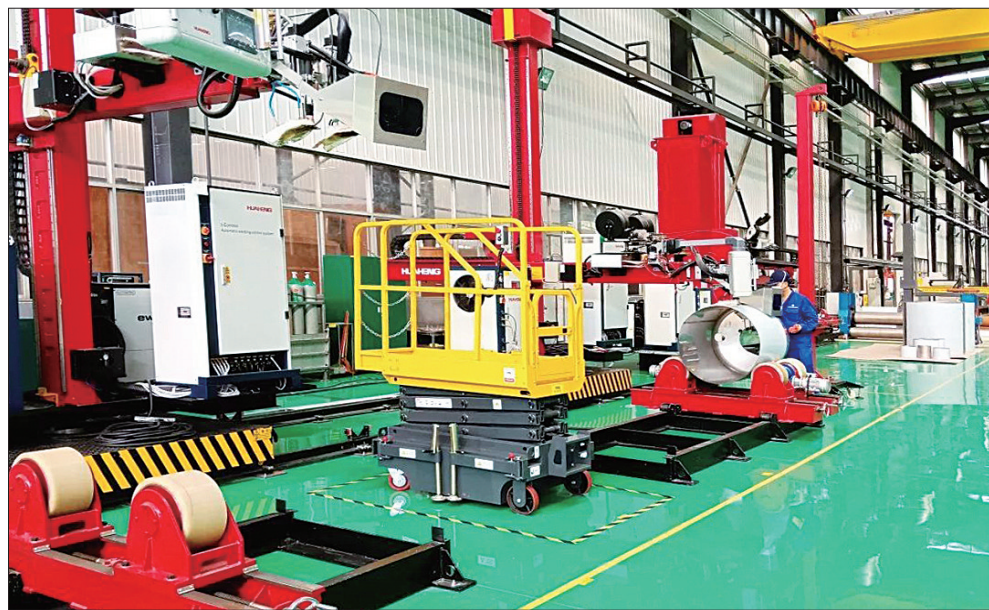
日前,徐州银轮机械有限公司新厂区自动化热交换器配件加工线试产,该线配置自动上下件机械手,全流程数据模块管理,智能化程度行业领先,较以往工作效率提高了3倍以上。图为技术人员调试配件机械。
