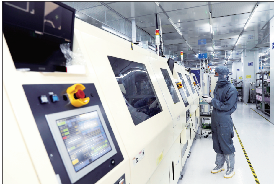
近日,明日能源科技公司新引进的圆柱18650电池模组生产线投入试产,能量密度100-130wh/kg,已通过GB/T31485/31486-2015各实验项目检测。图为新产线一角。
