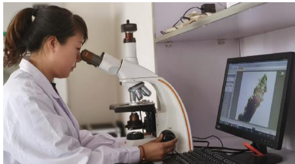
近日，阿龙山森工公司开展松针红斑病毒原孢子捕捉实验室镜检专项调查工作。技术人员从塔岗空林场生态功能区选取5棵樟子松样树，在1至1.3米高度悬挂涂抹凡士林的载玻片，24小时后带回实验室，在显微镜下观察，分析病原孢子数量的变化，掌握病害的发生时间、发生程度和传播路线。
