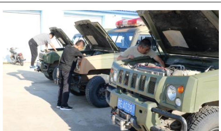
近日，图里河森工公司应急事务处组织人员检修消防车，对磨损严重的零部件进行更换，确保行车安全。王禹贺 摄
