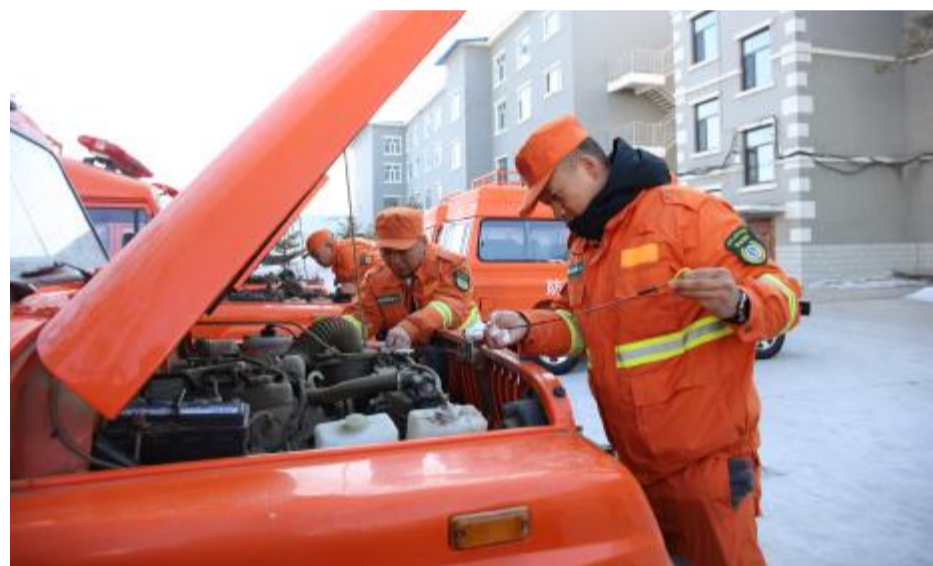
3月13日,大杨树林业有限公司应急事务处组织扑火队员对防火车辆、灭火机具等防火设备进行全面检修保养,确保完好率达到100%。 ■ 李志凤 王雨萌 摄
