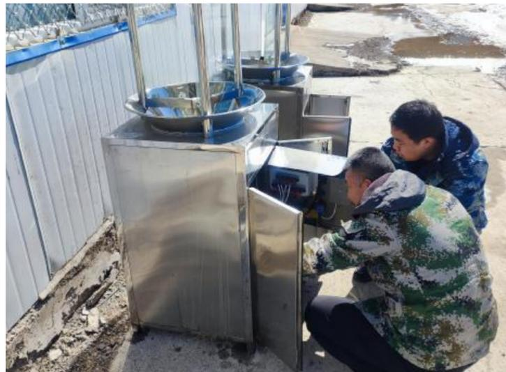
近日,库都尔森工公司森防站开展设备调试和维修保养工作,为精准预报和防控提供保障。图为技术人员检修虫情测报灯线路。 ■ 张丽 摄
