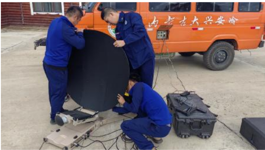
近日，库都尔森工公司应急事务中心开展通信演练，以实战标准检验便携式卫星地面站、无人机等设备在应急调度指挥中的作用，不断提升应急通信能力。因为工作人员组便携卫星地面站。
