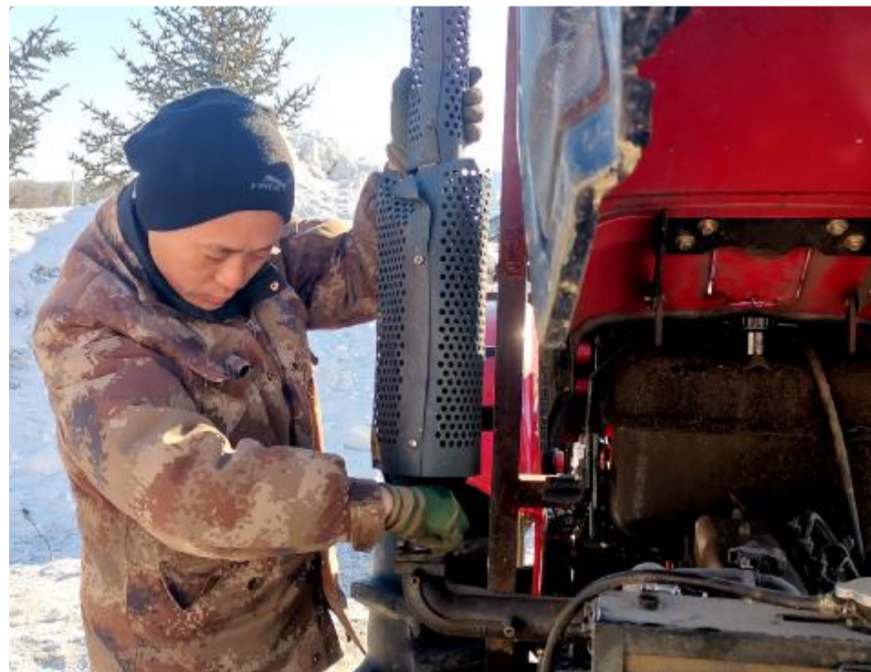
近日，克一河森工公司进一步强化生产设备维护保养，提升设备工作效能，确保生产经营工作顺利开展。 图为应急事务中心工作人员为拖拉机安装排气管。
