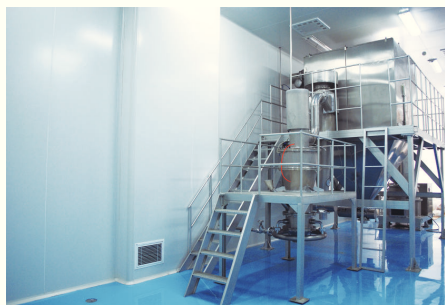
超微粉碎设备 专利类别：实用新型专利 专利号：ZL 2014 2 0598882.1 专利名称：共用气源系统与粉尘收集伺服系统的组合式超微粉碎机
