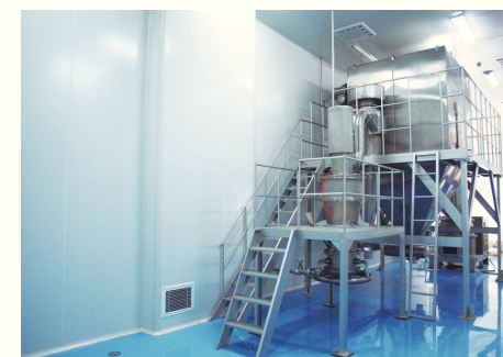
超微粉碎设备 专利类别:实用新型专利 专利号:ZL 2014 2 0598882.1 专利名称:共用气源系统与粉尘收集伺服系统的组合式超微粉碎机
